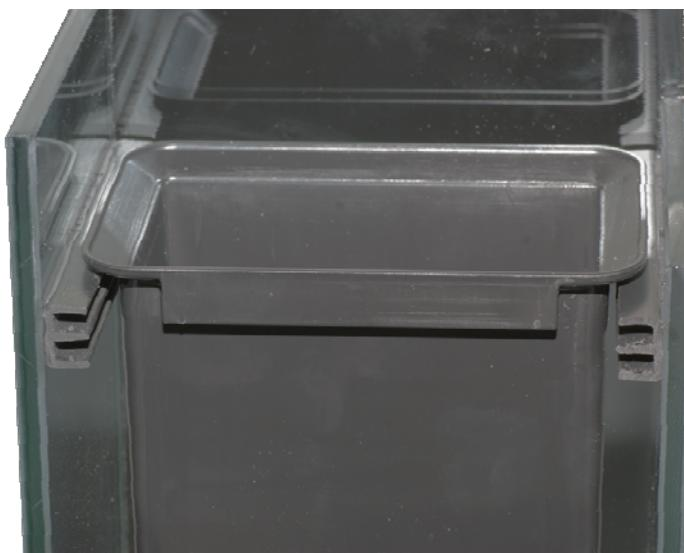
Der Filterkorb kann, wie in der Abbildung zu sehen, von oben in das Halteprofil eingehängt werden. Auf diese Weise ist er jederzeit herausnehmbar. Die Rückwand muss dazu nicht entfernt werden. Schiebt man ihn bei herausgezogener Rückwand in die obere Schiene des Profils ein, lässt sich nur ein Filterbeutel ohne vorheriges Entfernen der Rückwand entnehmen.
